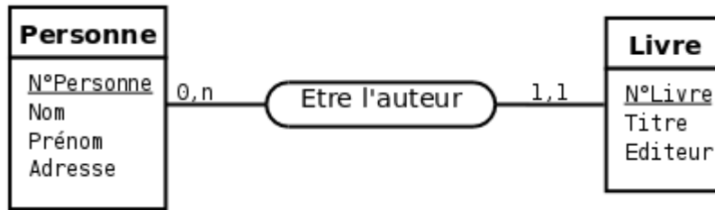
Figure 2.5: Représentation graphique des cardinalités d'un type-association. Dans cet exemple pédagogique, on suppose qu'un livre ne peut posséder qu'un auteur.
