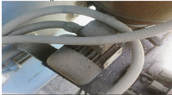
Figure 6 : Moteur asynchrone M63B4
