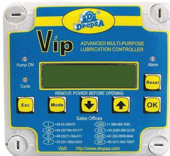
Figure 9 : Panneau de commande VIP 5
