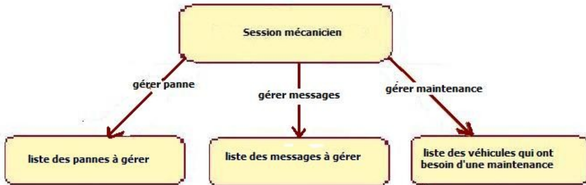
Figure 25 : Diagramme d'état-transitions concernant l'interface « session mécanicien »
