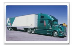
Un véhicule articulé est compensé d'un tracteur routier et une semi-remorque.
