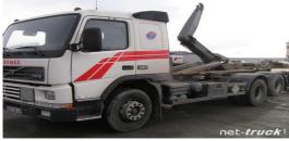
Ce type de porteur est équipé d'une caisse amovible. Un système Ampli roll est un système de carrosserie industrielle amovible.
