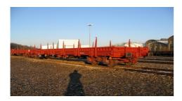
Wagon sans toit, sans bords latéraux ou muni de hausses ayant 60 centimètres au maximum, ou wagon à traverses pivotantes. Ces wagons peuvent être de type ordinaire ou spécial. Remarque: Les wagons conçus exclusivement pour le transport de conteneurs, de caisses mobiles et de véhicules de transport de marchandises sont exclus.
