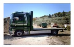
C'est un porteur destiné à des produits volumineux et/ou de grandes longueurs (automobile; produits métallurgiques tels que les rails, cuves, poutrelles, etc.). Des ridelles autour des porteurs permettent de mieux maintenir les chargements.
