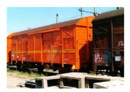
Wagon caractérisé par l'étanchéité de sa construction (parois sur toute la hauteur et toit) et par la sécurité du transport (wagon pouvant être fermé au cadenas ou plombé). Dans les wagons couverts sont inclus les wagons à toit ouvrant et les wagons isothermes, réfrigérants ou frigorifiques.
