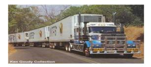
Comme son nom l'indique, un <u>Train</u> routier comporte un <u>véhicule</u> tracteur suivi de véhicules remorqués et se déplaçant sur le sol sans l'aide de rails, et pouvant transporter des charges très importantes.
