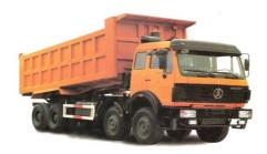
Le camion benne fait partie de la grande famille des Porteurs, c'est un véhicule destiné à transporter des marchandises de type : sable, roche, poudre, terre...
