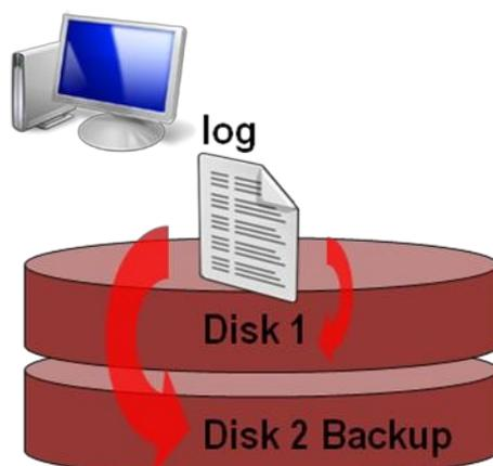
Certains pourront dire qu'avec le RAID on obtient déjà une sauvegarde, mais la différence est que le RAID n'effectue aucune vérification des données. Si un fichier de log est corrompu LCR permet de s'en prémunir en générant une alerte, à l'inverse du RAID qui fait une simple copie.
