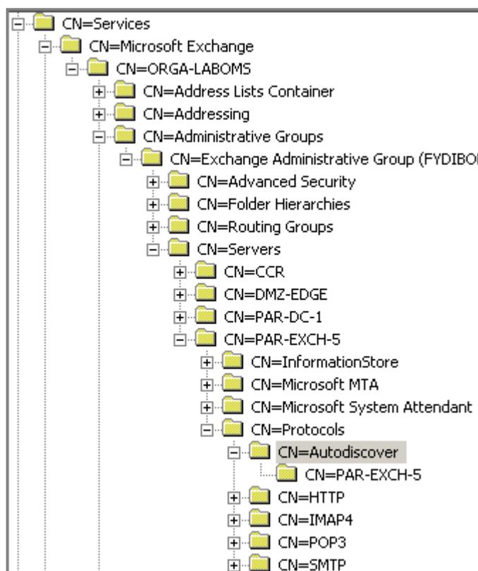
L'objet de type "point de connexion de service" ou **SCP** (*Service Connection Point*) est créé lors de l'installation d'un serveur CAS ou lors de l'ajout du rôle CAS sur un serveur existant. Cet objet est créé dans la partition de configuration de l'annuaire Active Directory (et plus précisément dans le conteneur **CN=Microsoft Exchange** qui stocke tous les paramètres de l'organisation). L'objet SCP porte le nom du serveur Exchange considéré (dans notre exemple il s'agit de *PAR-EXCH-5*).
