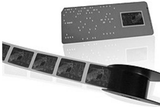
Cartes à fenêtres sont des cartes Hollerith dans laquelle un trou a été coupée. Une puce 35 mm microfilm est montée dans le trou à l'intérieur d'un manchon en plastique transparent, ou fixé sur l'ouverture par une bande adhésive. Ils sont utilisés pour les dessins techniques, pour toutes les disciplines du génie. Il existe des bibliothèques de ces contenants plus de 3 millions de cartes. Cartes à fenêtre peuvent être rangés dans des tiroirs ou dans des unités autonomes rotatifs.
