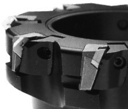
Figure 14 - Position des plaquettes sur la fraise
