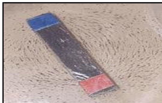
Fig. A.3: LES LIGNES DE CHAMP D'UN AIMANT DROIT
