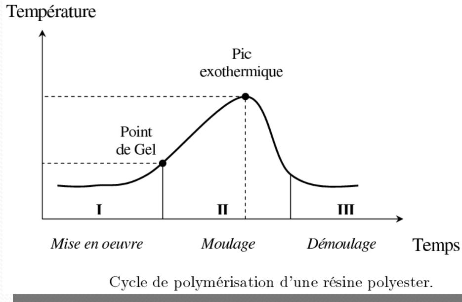
La réaction est exothermique et la température de la résine augmente progressivement depuis le gel jusqu'à un maximum correspondant au pic exothermique.
