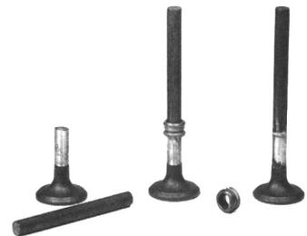
**Figure 59 : Soudage de la tige de soupape à la base**
