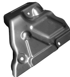
Figure 44 : Le principe le plus utilisé, le serre-flan s'oppose à la formation des plis
