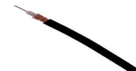
Le câble RG58 est un câble coaxial de 50 Ohm d'impédance caractéristique. C'est une ligne de transmission. Il se compose d'une gaine en plastique, d'une tresse de blindage, d'un isolant ainsi que d'une âme aussi appelé point chaud.
