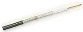
Câble à faible perte avec diélectrique mousse et conducteur central tressé, double blindage. Du au petit diamètre extérieur il est flexible comme le RG-58, mais avec beaucoup moins de pertes. Utile pour les nappes de câbles d'équipement et les câbles de réseau WLAN courts.
