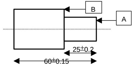
L'usinage de la surface B se fait avec la prise de pièce ci-contre :
