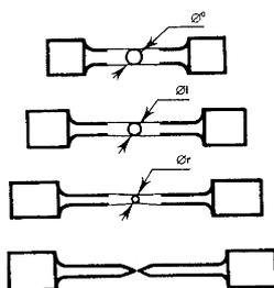
La striction est un point de diminution rapide du diamètre. Ceci explique la décroissance de la courbe de traction juste avant la rupture (le calcul
