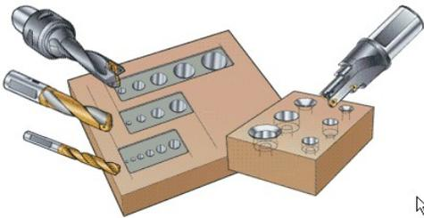
Le perçage est une forme de fraisage avec une caractéristique particulière : l'outil doit plonger dans la matière. Il faut donc qu'il soit capable de couper au centre (zone où la vitesse de coupe est nulle).
