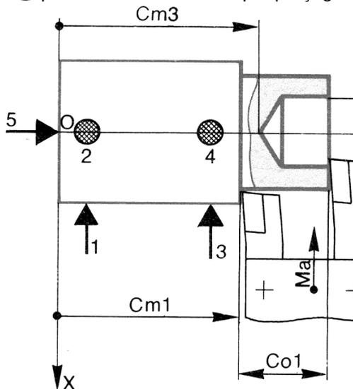
Exemple 2 : largeur d'une rainure obtenue par outil à rainurer
