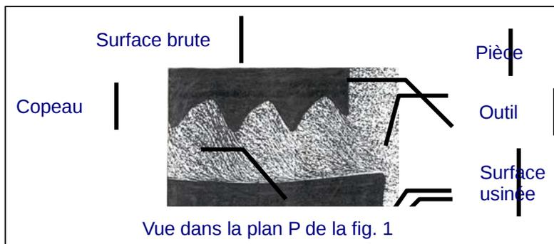
On observe, en faisant une coupe et une attaque chimique, le glissement plastique des filets qui sont parallèles entre eux, ainsi que la formation de vagues : le festonnage.
