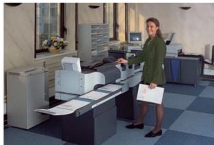
Ci-dessus : une plieuse et une chaîne de mise sous enveloppe
