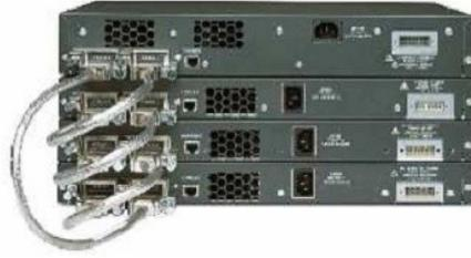
**Figure 53 : Empilement de commutateurs Cisco Catalyst 3750**
