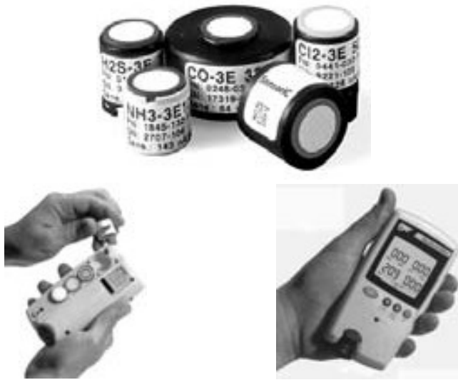
Figure 20.8 Capteurs ampérométriques pour gaz (Amperometric Gas Sensors). Assortiment de capteurs de la société ATMISensoric Div. (Ger.). Modèle GasAlertMax3-DL de la société BW Technologies (Can.); La photo centrale montre le compartiment où sont rangés les 4 détecteurs spécifiques aux 4 gaz détectables simultanément. Après avoir franchi une barrière de diffusion spécifique afin de ne pas saturer le capteur, le gaz est oxydé ( \text{CO}, \text{H}_2\text{S}, \text{NO}, \text{H}_2, \text{HCN} ) ou réduit ( \text{Cl}_2, \text{NO}_2 ) en présence de l'électrolyte au contact d'une électrode de travail de grande surface.
