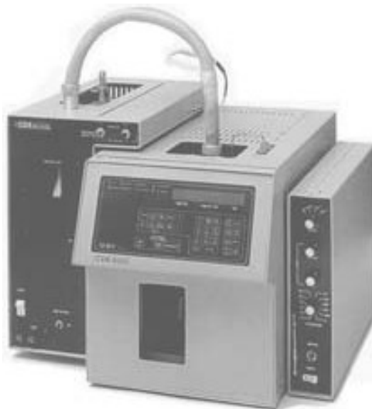
Figure 21.6 Espace de tête, modèle dynamique associé avec un chromatographe en phase gazeuse. Les flacons d'échantillon sont pressurisés avec le gaz vecteur du chromatographe. Le système « purge and trap » combine la préparation (simple) de l'échantillon, sa désorption et son introduction dans la colonne du chromatographe (modèle EA600 reproduit avec l'autorisation de la société CDS Analytical).
