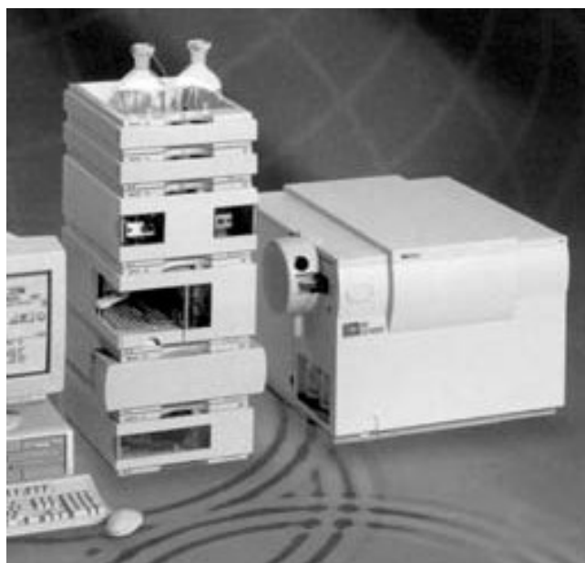
Figure 2.1 Schéma d'une installation de CLHP avec double détection. Un exemple de réalisation de type modulaire.
