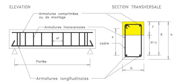
Soit une poutre de portée l et de section transversale b h :
