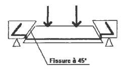
En augmentant les charges appliquées, des fissures à 45° se créent au niveau des deux zones d'appuis provenant d'une insuffisance de résistance du béton à l'effort tranchant.
