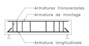
Ajoutons maintenant des armatures transversales particulièrement au niveau des appuis.
