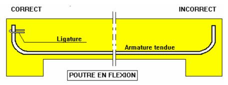
Il convient soit de disposer une ligature ancrée dans la masse du béton, soit mieux, d'incliner le retour de l'ancrage vers la masse du béton pour obtenir alors un crochet (article A.7.4,3 du BAEL91).
