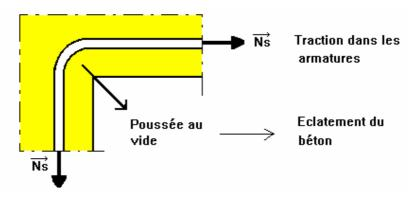
Si la poussée est orientée vers une face externe, il y a risque d'éclatement du parement. Il faut donc, pour éviter les poussées au vide, choisir un tracé judicieux des armatures. Par exemple, les poussées doivent être, dans les courbures, orientées vers la masse du béton.
