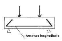
Nous disposons des armatures en fibre inférieure, là où se développent les contraintes de traction et donc là où le béton montre des insuffisances.
