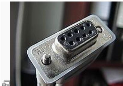
Prise femelle extrémité de câble type DB-9
