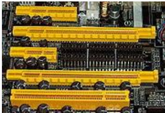
Slots PCI Express: du haut en bas x4, x16, x1 et x16 comparés à un slot PCI 32 bits (en bas)
