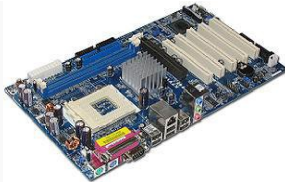
Une carte mère de compatible PC x86 équipée de chipset
