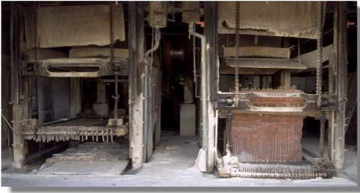
Châssis de scie multi lames Decamps en 1993, marbrerie Yelmini Artaud (autrefois Célard), Saint-Amour - Photo : Inv. Y. Sancey - © Inventaire général, ADAGP, 1993
