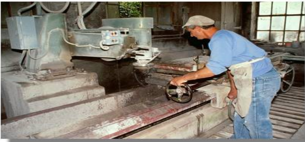
Moulurage d'une plaque de marbre à la marbrerie Yelmini Artaud, Balanod - Photo : Inv. Y. Sancey - © Inventaire général, ADAGP, 1997.
