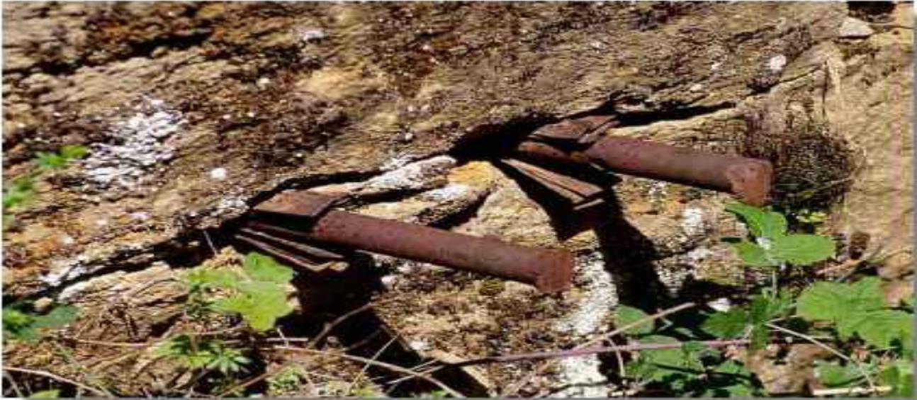
Coins en place dans le front de taille de la carrière des Carrats, commune de Graye-et-Charnay - Photo : Inv. Y. Sancey - © Inventaire général, ADAGP, 1997.
