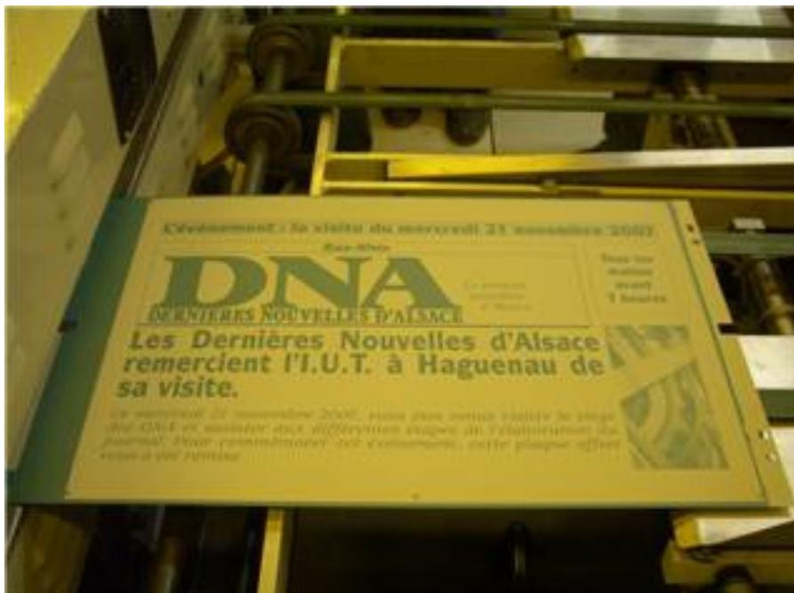
La plaque en aluminium qui sort de la machine et qui est prête à être placée sur le cylindre porte plaque à ces deux extrémités. (DNA°)
