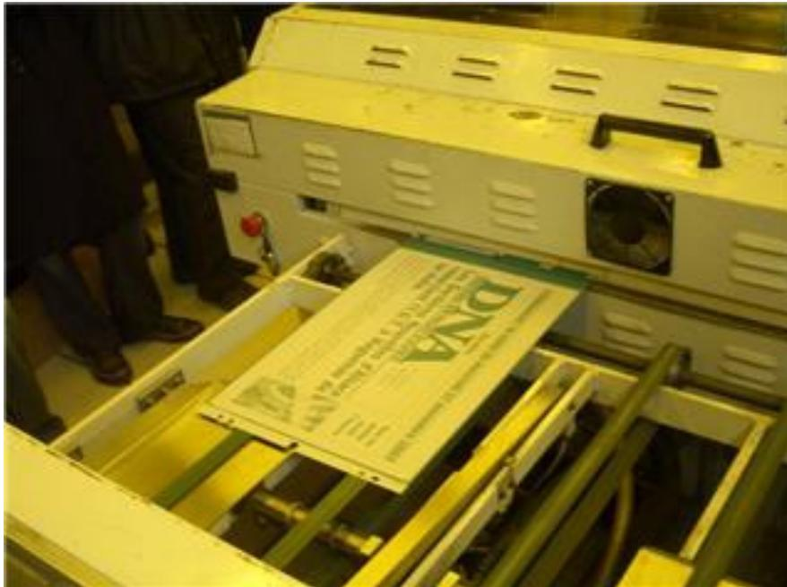
Le film insolé sur la plaque en aluminium grâce à la machine « polychrome » (DNA)
