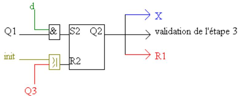
Il suffit de répéter cela pour chaque étape et relier le tout. Le schéma de câblage du système complet sera donc (j'ai gardé la même disposition que le Grafcet, mais retourné de 90 degrés, les électroniciens préfèrent les entrées à gauche et les sorties à droite) :
