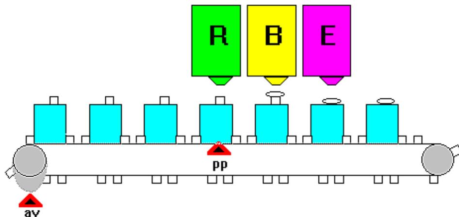
Un seul capteur détecte la présence d'un bidon en début de chaîne : pp. On désire faire les 3 opérations simultanément, sauf s'il n'y a pas de bidon sous le poste. S'il vous semble obligatoire de rajouter des capteurs, vous n'avez RIEN compris au Grafset puisqu'il vous faut un système combinatoire (il vaut mieux alors câbler en combinatoire chaque poste : avance tapis ET présence bidon => effectuer l'action). On suppose que le tapis est vide lors de l'initialisation.
