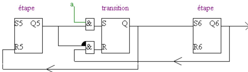
Cette méthode permet de régler le cas où l'étape 5 risque d'être réactivée avant la désactivation de 6.
