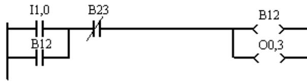
Dans ce cas l'entrée B12 est l'ancienne valeur du bit interne (bobine) B12. Si l'on veut utiliser le résultat B12 de ce réseau, il faut utiliser B12 dans le réseau suivant.
