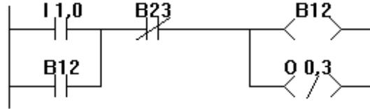
Dans ce cas l'entrée B12 est l'ancienne valeur de la bobine (variable interne) B12. Si l'on veut utiliser le résultat de ce réseau, il faut utiliser B12 dans le réseau suivant.
