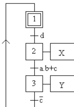
On peut gérer de différentes manières l'étape initiale. Dans la plupart des cas, le plus simple est d'utiliser des bascules se mettant à 0 à la mise sous tension, et d'initialiser l'automatisme à l'aide d'un bouton que je noterai ici "init", qui peut également servir à réinitialiser le Grafcet en cours de fonctionnement sans éteindre le système.
