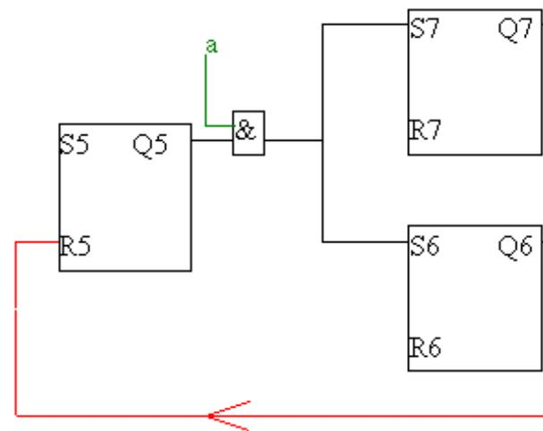
Ce câblage simple ne répond pas aux règles du Grafset si 5 peut être réactivé avant que 6 et 7 n'aient été désactivées. Il en est de même si l'étape 7 par exemple peut être activée d'une autre manière (convergence en OU). Ces cas sont cependant très rares dans la pratique.
