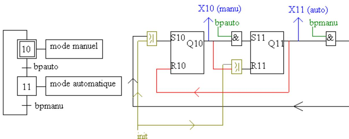
Quand 10 est actif (Q10) et bpauto vrai, en même temps on essaie d'allumer 11 par S11 et de l'éteindre par R11. Même en prenant une bascule à priorité déclenchement, l'état de 11 sera celui du dernier signal sur ses broches, ce qui risque d'être aléatoire.
