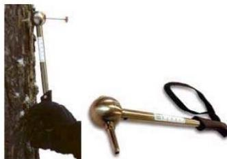
Figure 5 : Le marteau sondeur.
