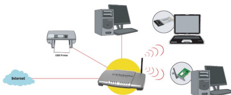
Figure A : les réseaux locaux sans fils (WLAN 802.11).
