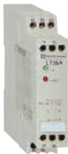
↑ Fig. 62 Dispositif électronique (LT3 - Telemecanique) à associer à trois sondes à thermistance, pour commander l'arrêt d'un moteur en dépassement de température
